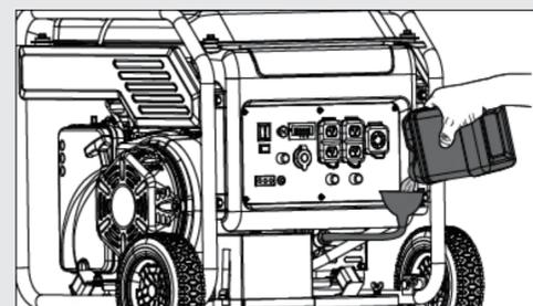
**3** 將發電機置於水平地面打開燃油箱頂部添加汽油。F為填滿，呈現E時必須再添加。添加完畢後蓋上汽油蓋。請勿添加過多汽油並將油箱蓋確實鎖緊周圍清理乾淨。
